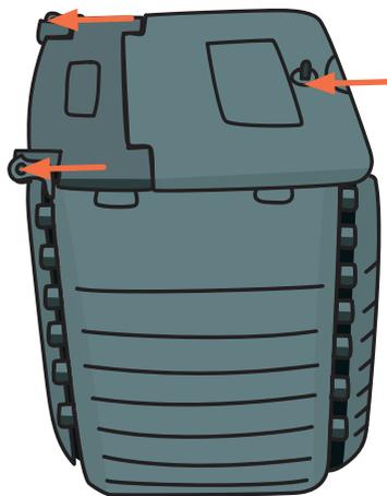
Glissez le couvercle en insérant les taquets dans les œillets.
